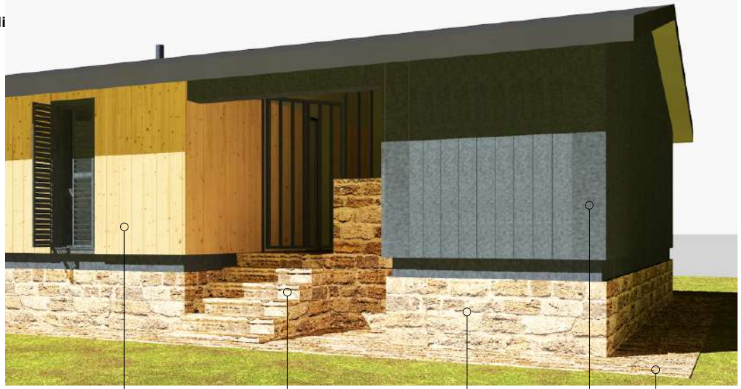
LWSS wall / YÇPK Divar Stone-work stairs Nərdivan təbii çay daşından Socle stone-work Zirzəmi (sokol) təbii çay daşından LSS wall / LLC Divar Cobble riprap contour Çay daşından özülü
